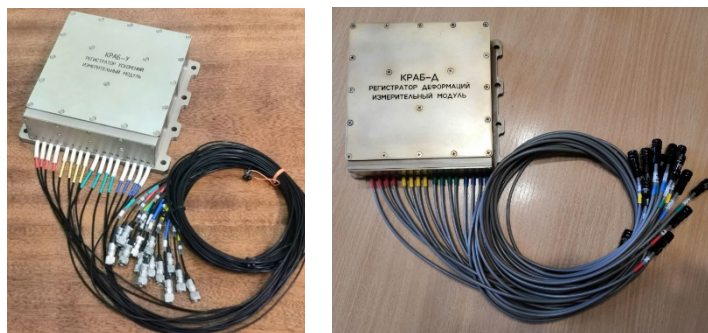
Рис. 6. Автономные ударостойкие приборы линейки «КРАБ»: «КРАБ-У» и «КРАБ-Д»
