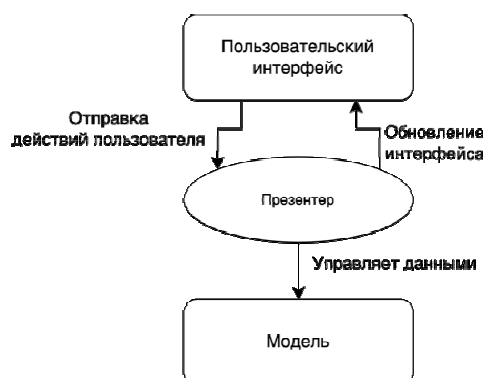
Рис. 2. Схема архитектуры MVP
