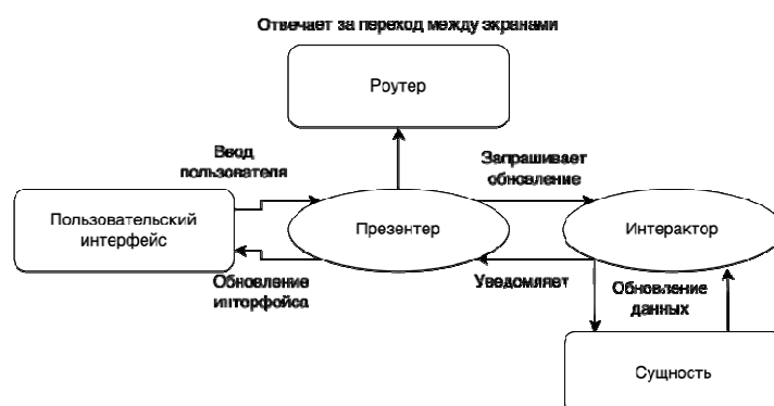
Рис. 4. Схема архитектуры VIPER
