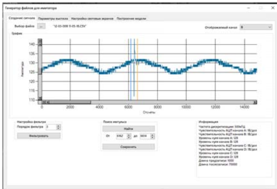
Рис. 3. Реальные сигналы, снятые с выходов оптических датчиков
